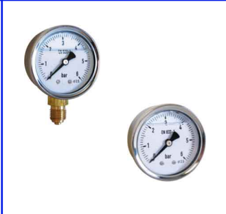
manometer diam. 50 mm klasse 2,5 vacuüm : -1 +1 bar druk : 0 - 1,6/2,5/4/6/10/16/25/40/60 bar glycerine gevuld aansluiting en binnenwerk in messing kast RVS 304 fig 653 : 1/4" bsp radiaal (onder) fig 654 : 1/4" bsp axiaal (achter)
