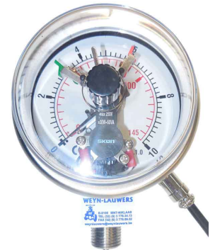
kontakt-manometers in RVS druk : 0 - 10 bar / 0 - 16 bar droge uitvoering aansluiting en binnenwerk in RVS 316 kast RVS 304 / connector + kabel 0,5 m 2 instelbare droge kontakten 30W/50VA temp. : -20°C +120°C fig 648 : klasse 1,6 / 1/2" bsp radiaal (onder) diam. 100 mm
