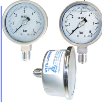
manometer diam. 100 mm klasse 1,0 vacuüm : -1 +1 bar druk : 0 - 1,6/2,5/4/6/10/16/25/40/60 bar fig 673 : droge uitvoering fig 671 : glycerine gevuld aansluiting / bourdon in RVS 316 kast RVS 304 1/2" bsp radiaal aansluiting (onder) fig 675 : glycerine gevuld, 1/2" axiaal (achter)
