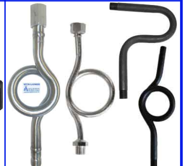
sifonpijp / hoge druk met wartel 1/2" MF bsp max. temp. : +300°C bij 80 bar / din 16282-C fig 678 : stalen uitvoering / fig 679 : in RVS sifonpijp PN25 1/4" of 1/2" bps fig 680 : stalen uitvoering zonder wartel fig 681 : stalen uitvoering U-type zonder wartel fig 682 : RVS uitvoering met wartel fig 683 : koperen uitvoering met wartel
