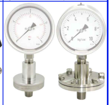
scheidingsmembranen 1/2" in RVS316 max. werkdruk : 40 bar / temp. : -40°C +150°C DT108 : 1/4" of 1/2" bsp - gelaste uitvoering DT110 : 1/4" of 1/2" bsp - demonteerbaar DT122 : flens dn15/20/25 PN16/40 DT106 : clampaansluiting 50,5 of 64 mm DT185 : SMS wartel 2" F
