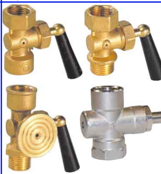
manometerkraan PN16 in messing max. temp. : +120°C fig 690 : 1/2" FF bsp fig 691 : 1/2" MF bsp fig 696 : 1/2" MF bsp met proefflens fig 698 : met drukknoop en veer / PN4 1/4" FF of 1/2" FF bps
