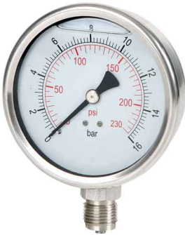
manometer diam. 100 mm klasse 1,6 fig 672 : 0 - 2,5/4/6/10/16/25/40/60/100 bar dubbele schaal in psi glycerine gevuld kast RVS 304 aansluiting / bourdon in RVS 316 1/2" bsp radiaal aansluiting (onder)
