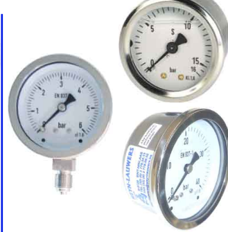
manometer diam. 63 mm klasse 1,6 vacuüm : -1 +1 bar druk : 0 - 1,6/2,5/4/6/10/16/25/40/60 bar fig 662 : droge uitvoering 1/4" bsp radiaal fig 662GLY : glycerine gevuld 1/4" bsp radiaal fig 663 : droge uitvoering 1/4" bsp axiaal fig 663GLY : glycerine gevuld 1/4" bsp axiaal aansluiting / bourdon in RVS 316 kast RVS 304
