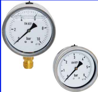
manometer diam. 100 mm klasse 1,0 vacuüm : -1 +1 bar druk : 0 - 1,6/2,5/4/6/10/16/25/40/60 bar glycerine gevuld aansluiting en binnenwerk in messing kast RVS 304 fig 669 : 1/2" bsp radiaal (onder) fig 670 : 1/2" bsp axiaal (achter)
