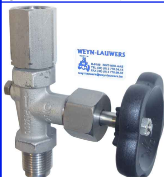
manometerkraan hoge druk PN400 voorzien van wartel volgens din 16282 type C max. temp. : +200°C aansluiting 1/2" MF bsp fig 693 : stalen uitvoering fig 694 : RVS uitvoering
