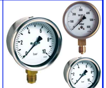
droge manometers klasse 1,6 druk : 0 - 1,2/5/4/6/10/16/25 bar aansluiting, binnenwerk: messing / kast RVS304 fig 667 : dia. 100 mm - 1/2" bsp radiaal (onder) fig 657 : dia. 63 mm - 1/4" bsp radiaal (onder) manometers in mbar druk : 0 - 60/100/250/400/600 mbar fig 668 : dia. 100 mm - 1/2" bsp radiaal (onder) fig 658 : dia. 63 mm - 1/4" bsp radiaal (onder)
