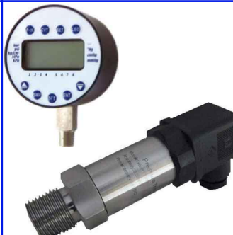
druk transmitters 1/2" bsp fig 699 : range van -1 tot +500 bar mogelijk input : 11-36 V output : 4-20 mA uitvoering aansluiting 1/2" MF bsp fig 699D : digitale uitvoering / kast 80 mm programmeerbare display / 1/4" bsp range van 0 tot +20 bar mogelijk
