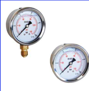
manometer diam. 63 mm klasse 1,6 vacuüm : -1 +1 bar druk : 0 - 1,6/2,5/4/6/10/16/25/40/60 bar druk : 0 - 100/160/250/400 bar - psi schaal glycerine gevuld aansluiting en binnenwerk in messing kast RVS 304 fig 660 : 1/4" bsp radiaal (onder) fig 661 : 1/4" bsp axiaal (achter)
