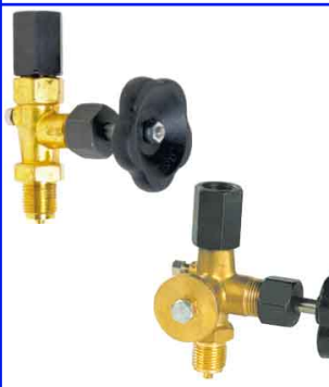
manometerkraan hoge druk PN250 voorzien van wartel huis in messing / wartel in staal max. temp. : +120°C aansluiting 1/2" MF bsp fig 692 : standaard uitvoering fig 697 : uitvoering met proefflens
