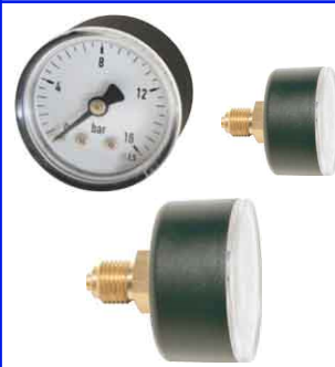
manometer met ABS kunststof kast klasse 2,5 plexiglas scherm - droge uitvoering druk : 0 - 1,0/2,5/4/6/10/16/25 bar aansluiting en binnenwerk in messing fig 656 : diam. 63 mm - 1/4" bsp axiaal fig 652 : diam. 50 mm - 1/4" bsp axiaal fig 650 : diam. 40 mm - 1/8" bsp axiaal
